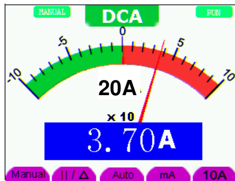
Abbildung 28: Gleichstrommessung <20 A (DCA)
