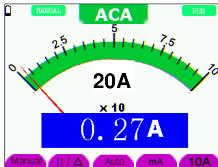
Abbildung 30: Wechselstrommessung <20 A (ACA)
