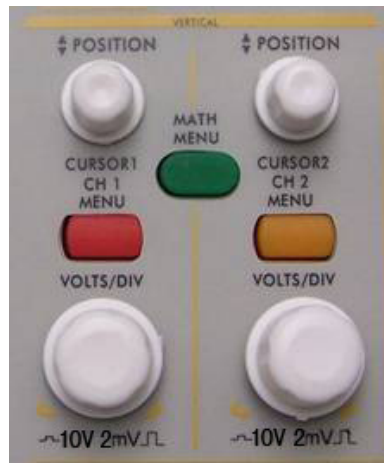
Abb. 8 Bedienelemente für Vertikalsteuerung
