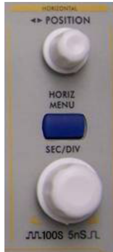
Abb. 9 Bedienelemente für Horizontalsteuerung
