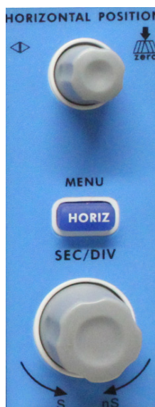
Abb. 11 Bedienelemente für Horizontalsteuerung
