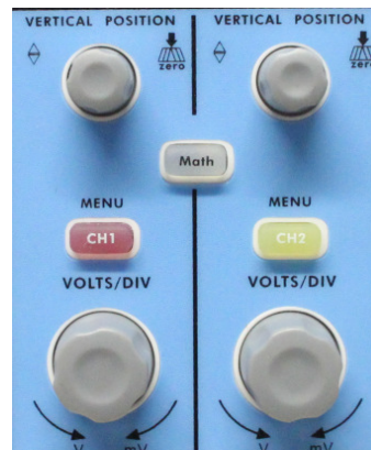
Abb. 10 Bedienelemente für Vertikalsteuerung
