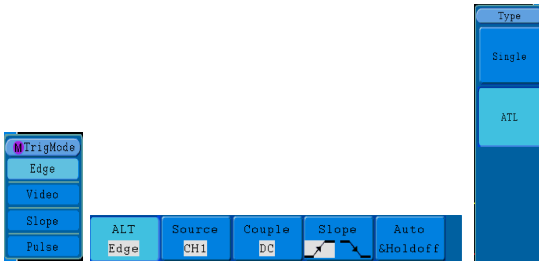
Abb.33 Menü für alternierenden Trigger (ALT) (Triggertyp: Edge)
